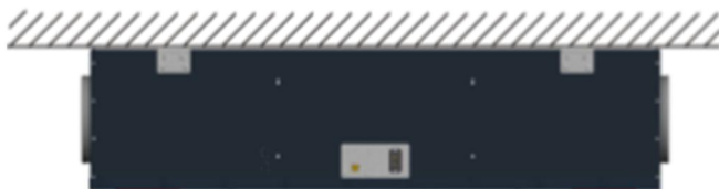
Obr. 9: montážní poloha – zavěšení pod strop
