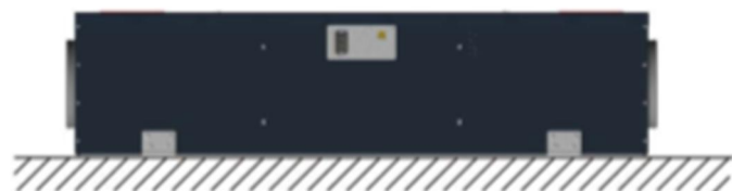
Obr. 10: Montážní poloha – ležící
