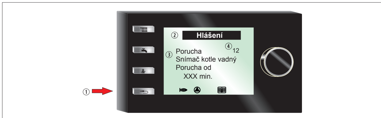
Obr. 11.1 Hlášení poruchy na zobrazovacím modulu AM
