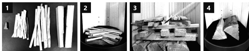
Obr. 4 Postup přípravy dřeva ve spalovací komoře
