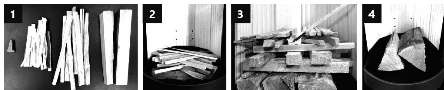
Kép 4. A fa előkészítési eljárása az égetőkamrában
