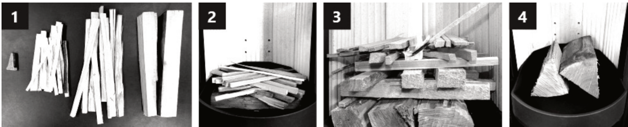
Kép 4. A fa előkészítési eljárása az égetőkamrában
