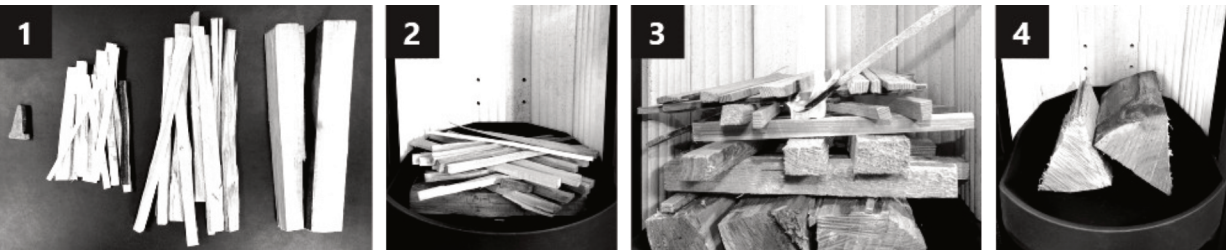
Obr. 4 Postup přípravy dřeva ve spalovací komoře
