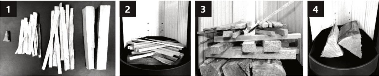
Obr. 4 Postup prípravy dreva v spaľovacej komore
