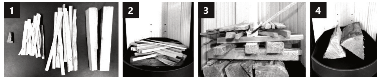
Рис. 4 Процедура подготовки древесины в камере сгорания
