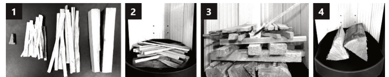
Rys. 4 Procedura przygotowania drewna w komorze spalania
