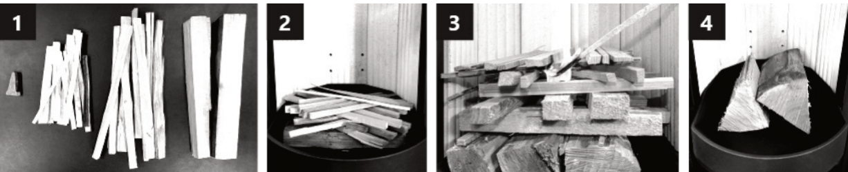
Obr. 4 Postup přípravy dřeva ve spalovací komoře
