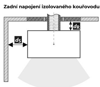
Prostup kouřovodu stěnou z hořlavé hmoty ČSN 06 1008
