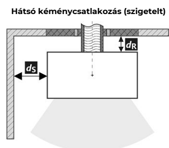
A füstcső áthaladása éghető anyagból készült falon
