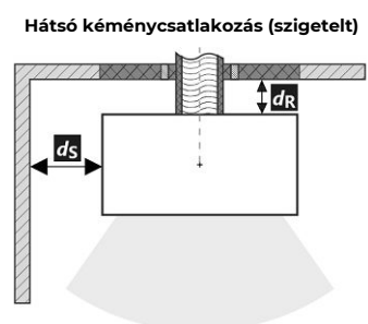
A füstcső áthaladása éghető anyagból készült falon
