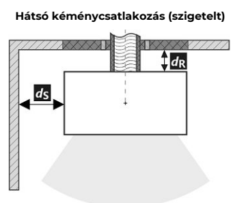
A füstcső áthaladása éghető anyagból készült falon
