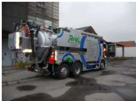
Vůz na čištění kanalizace
