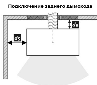
Проход дымовой трубы через стену из горючего материала
