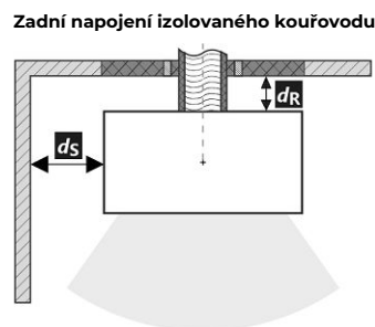
Prostup kouřovodu stěnou z hořlavé hmoty ČSN 06 1008
