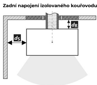
Prostup kouřovodu stěnou z hořlavé hmoty ČSN 06 1008
