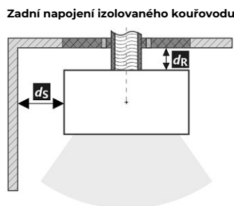
Prostup kouřovodu stěnou z hořlavé hmoty ČSN 06 1008
