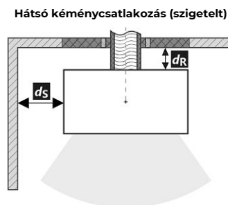
A füstcső áthaladása éghető anyagból készült falon
