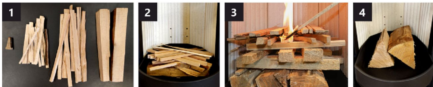
Obr. 1 Postup prípravy dreva v spaľovacej komore
