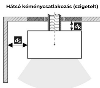
A füstcső áthaladása éghető anyagból készült falon
