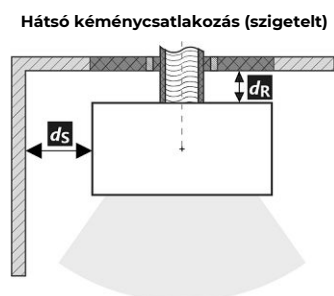
A füstcső áthaladása éghető anyagból készült falon
