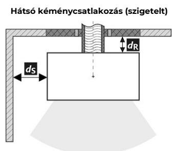
A füstcső áthaladása éghető anyagból készült falon
