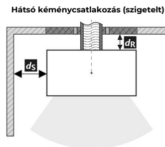
A füstcső áthaladása éghető anyagból készült falon
