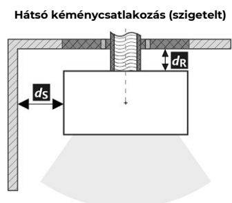
A füstcső áthaladása éghető anyagból készült falon
