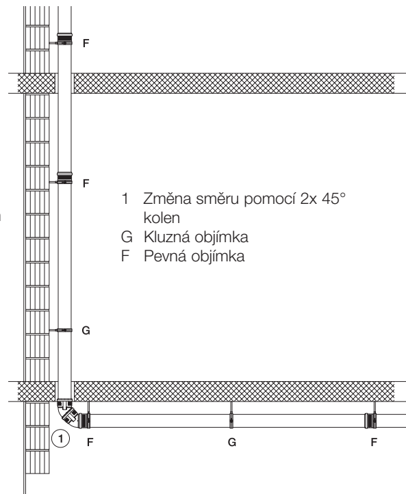
Obr. 17 Odpadní potrubí se změnou směru 2x 45°
