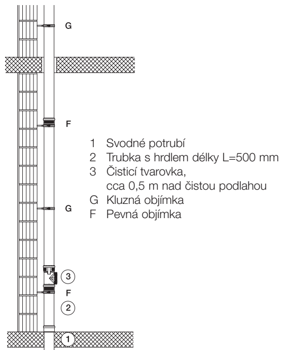
Obr. 16 Odpadní potrubí
